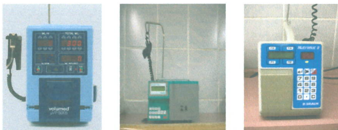
Figura 3 – Da esquerda para a direita, bombas de infusão dos modelos VOLUMED µVP 5005 – ARCHEMED, INFUSOMAT COMPACT- B. BRAUN e NUTRIMAT II – B. BRAUN.
